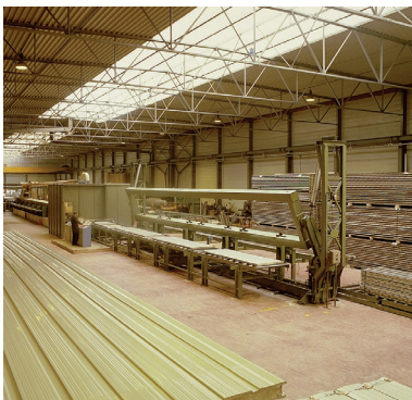
Foto di archivio storico: interni dello stabilimento Isolpack di Villanova d'Asti, 1972. La prima linea in continuo realizzata in Italia per la produzione di pannelli. Historical archive photo: interiors of the Isolpack plant in Villanova d'Asti, 1972. The first continuous line built in Italy for the production of panels.
